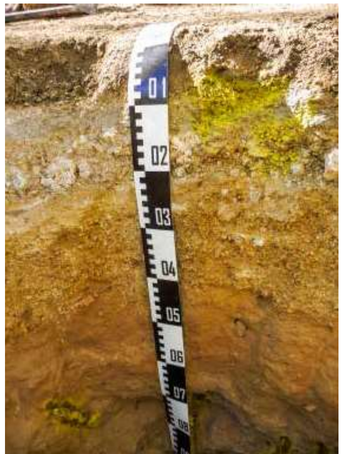
Abb. 3: Bodenprofil im Platanenrain; auffällig ist die äußerst geringe Durchwurzelung (gelbe Markierungen).
