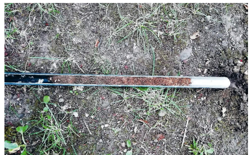
Abbildung 4: Schlagbohrstock mit Bodenprobe zur Ermittlung der Bodenfeuchte
