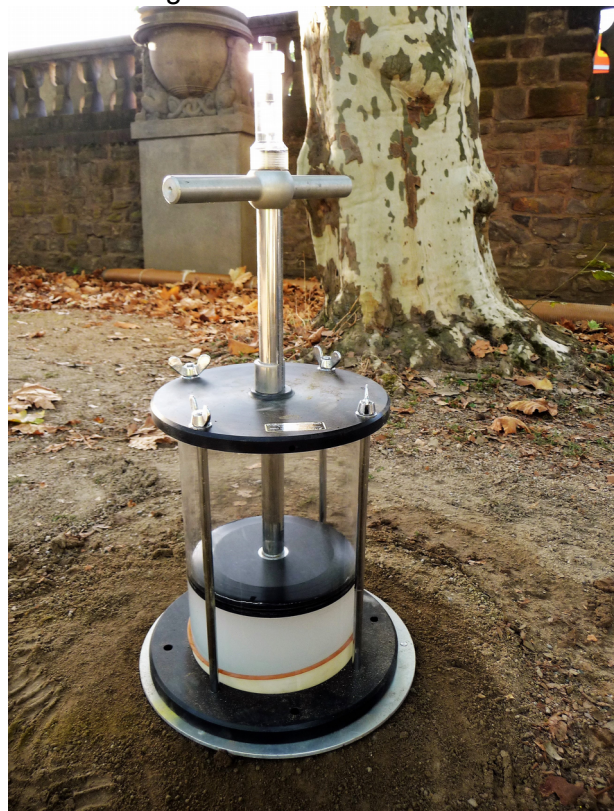
Abbildung 1: Bodendensitometer zur Messung der Trockenrohdichte im Ballon-Verfahren.
