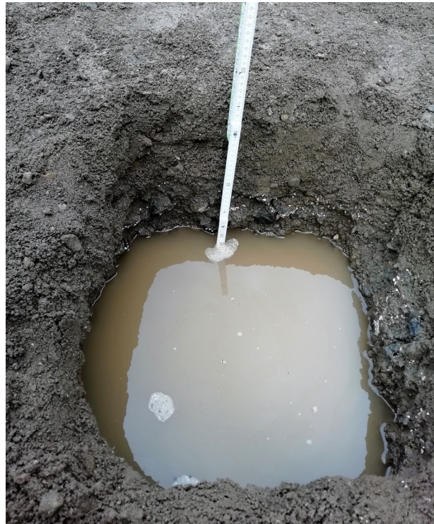
Abbildung 6: Messung der Wasserleitfähigkeit mittels des vereinfachten Verfahrens gemäß der FLL-Empfehlungen für Baumpflanzungen (2010).
