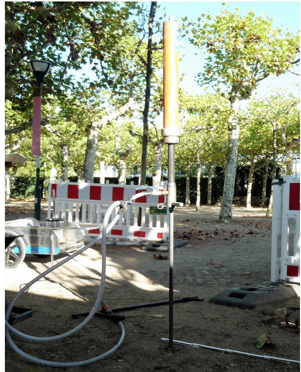
Abbildung 4: Leichte Rammsonde (DPL-10).
